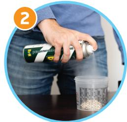
**2 Шаг.** Перед заливкой мастер модель рекомендуется обработать разделительным составом. На фото используется аэрозольный восковый разделитель BC-M.
