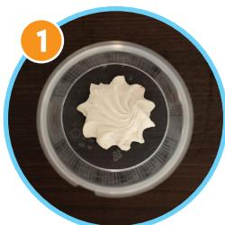
**1 Шаг.** Помещаем и фиксируем мастер модель (изделие, с которого будем снимать форму) в опалубку так, чтобы расстояние от стенок опалубки до мастер-модели составляло не менее 5 мм. и не более 1,5 см.
