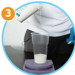
**3 Шаг.** Смешайте два компонента по массе в пропорциях 100 А и 2 Б. Время перемешивания от 2 до 5 минут. (Если в комплекте идет красный катализатор, цвет смеси должен быть розовый).
