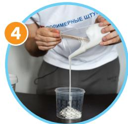
**4 Шаг.** Заливка материала. Заливка производится небольшой струей в одну точку, мастер модель должна полностью скрыться под слоем силикона.
