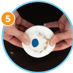
**5 Шаг.** Ждем застывания от 8 ч. до 12 ч. (в зависимости от температурного режима). Рекомендуемая температура в помещении +20°C до 24°C. Извлекаем изделие из формы.
